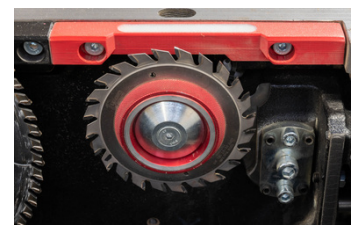
"LEADER" snelregelbare voorritser "LEADER" quick-adjust scoring unit Inciseur avant "LEADER" à réglage rapide
